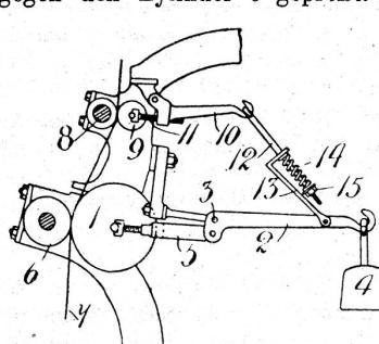
Die geeignete Lage des elastischen Verbindzuges ist deshalb gewählt, damit bei einer eventuell nötig werdenden Entlastung der Druckzylinder durch Anheben des Hebels 2 und Gewichtes 4, der Haken der Stange 12 auf dem Hebel 10 nach vorn gleiten und beim Widerherstellen des normalen Druckes an der Zugstelle sich wieder einhängen kann.
