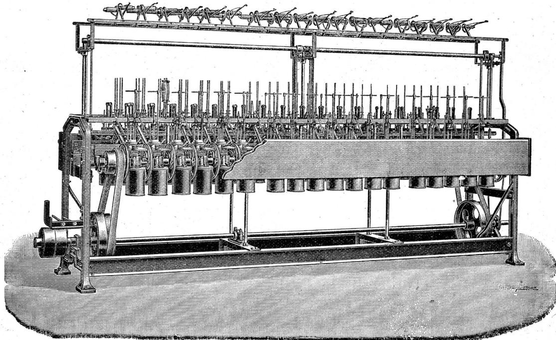
2-4000 Umdrehungen per Minute von Spindel mit 1 Läufer
