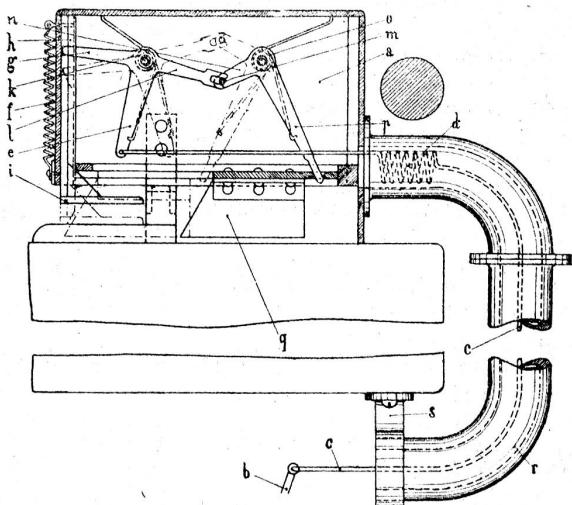
einer Feder  $f$  stehende Führungsstange  $h$ , welche am unteren Teil  $i$  tischartig ausgebildet ist, womit der Zweck verfolgt wird, bei jedem Schnitt der Gewebe so lange festzuklemmen, bis der Schnitt erfolgt ist. Der Einfluss der Spiralfeder  $k$  wird durch Einstellen von Stiften geregelt.
