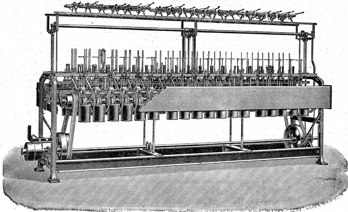
2—4000 Umdrehungen per Minute von Spindel mit Läufer
