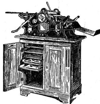
mit automat. Briefeinführung und automat. verstellbarer Abschneidevorrichtung. Einfachste Maschine, ohne komplizierten Mechanismus. Die sparsamste im Papierverbrauch.
