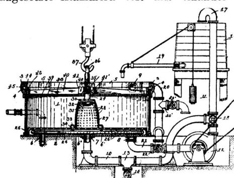
findet, erst die gesamte Packung durchdringen muss, ehe sie an der Deckelperipherie austreten kann. Auf diese Weise soll ein gleichmässiges Durchfärben des Materials erreicht und die Entstehung sogenannter Rinnen oder Streifen vermieden werden.
