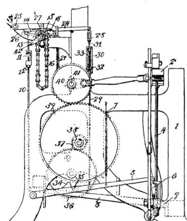
antreffen und denselben niederdrücken, wodurch das Fortschalten der Wechselvorrichtung erfolgt. Der Antrieb der Scheibe 36 geschieht, wie ersichtlich, von der Kurbelwelle 41 des Stuhles aus durch das Rädergetriebe 40, 39, 37. Die Hebel 5 und 24 sind mit Gegenzugfedern 7, bezw. 27 versehen.
