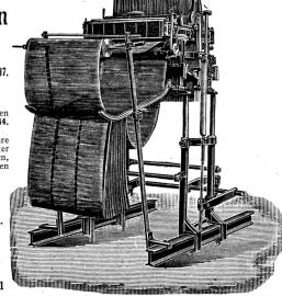
Doppelhub- und Zweizylinder-Jacquardmaschine Hochfach- Hoch- und Tieffach-Maschine
