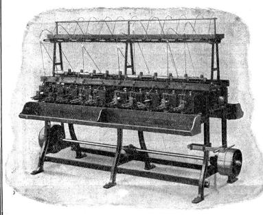
Patente angemeldet: Neue Kreuzschuss-Spulmaschine "RAPID".
