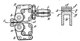
kannte Deckriemchen g und h vorgesehen, welche die Teilriemchen bis zur Abgabe des Florstreifens f begleiten. Dieser Florstreifen wird auf den mit gleicher Geschwindigkeit wie die Teilriemchen umlaufenden Nitschelhosen i und k in bekannter Weise verarbeitet, indem durch achsiale Hin- und Herbewegung der Nitschelhosen der Faden mit einer vorläufigen Drehung versehen wird.
