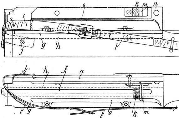
Am inneren Schützenkastenende wird der Treiber selbst überhaupt nicht aufgefangen, sondern durch den Schlagriemen in seiner Bewegung begrenzt, für den ein feststehender Anschlag *k* oberhalb der Treiberbahn angeordnet ist, so dass dieser Anschlag auch dem ein- und austretenden Schützen nicht mehr im Wege ist.
