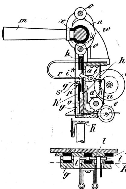
Biegeblöcke ragen durch in den Seitenführungen vorge sehene Durchbrechungen in den von den Schlagstempeln  $i$  bestrichenen Raum hinein und werden aus diesem vor dem Niedergang der Schlagstempel durch mit den die Klammer bildenden Stempeln verbundene Klingen  $v$  zurückgezogen.
