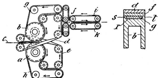
kannte Deckriemchen  $g$  und  $h$  vorgesehen, welche die Teilriemchen bis zur Abgabe des Florstreifens  $f$  begleiten. Dieser Florstreifen wird auf den mit gleicher Geschwindigkeit wie die Teilriemchen umlaufenden Nitschelhosen  $i$  und  $k$  in bekannter Weise verarbeitet, indem durch achsiale Hin- und Herbewegung der Nitschelhosen der Faden mit einer vorläufigen Drehung versehen wird.
