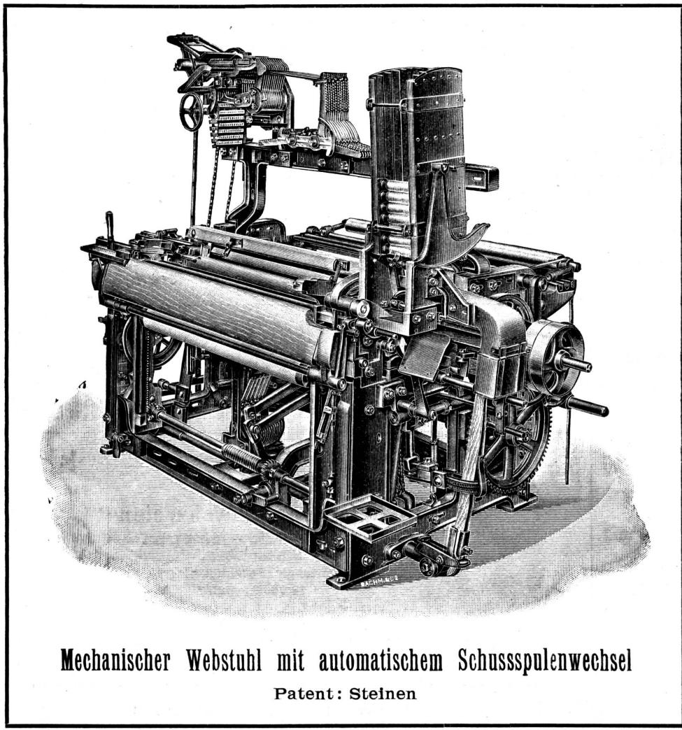
Mechanischer Webstuhl mit automatischem Schussspulenwechsel
