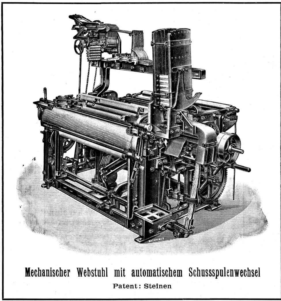
Mechanischer Webstuhl mit automatischem Schussspulenwechsel
