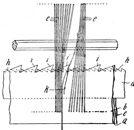
Fällt irgend eine Platine nieder, so wird sie von der beweglichen Schiene d erfasst und um ein den jeweiligen Abstand des sie mitnehmenden Zahnes von dem nächsten Zahn der feststehenden Zahnschiene entsprechendes Stück
