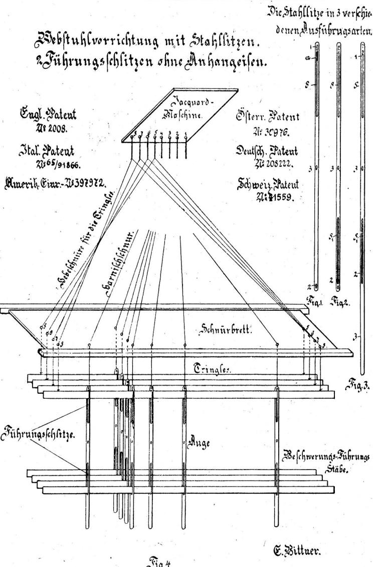
der Litzen während des Webeprozesses ausgeschlossen, ein rascherer und ruhigerer Gang des Webstuhles möglich. Die Litze kann für jede Kettendichte und jedes Material, ob Seide, Leinen, Baumwolle, Jute, Kammgarn etc., benutzt werden. Auch ist es möglich, mit dieser Litze „Damastgewebe“, sogen. „Tringlesgewebe“, die hauptsächlich in der Seiden-Jacquardweberei, eventuell auch in der Baumwoll-Jacquardweberei, vorkommen, herzustellen.
