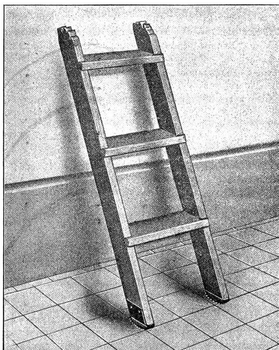
rein unmöglich gemacht. Es werden dadurch (namentlich in Fabriken) viele und schwere Unfälle vermieden. Ferner ist der Leiterschuh zur besten Schonung feiner Fussböden sehr zu empfehlen, da die Gummieinlage desselben auch die glatteste Fläche nicht angreift, und dennoch ein äusserst zuverlässiges Feststehen bewirkt.
