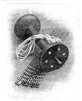
durch Auswechseln der Seitenstäbchen rasch einen Haspel für grössere oder kleinere Strangenweiten herstalde versandt werden.
