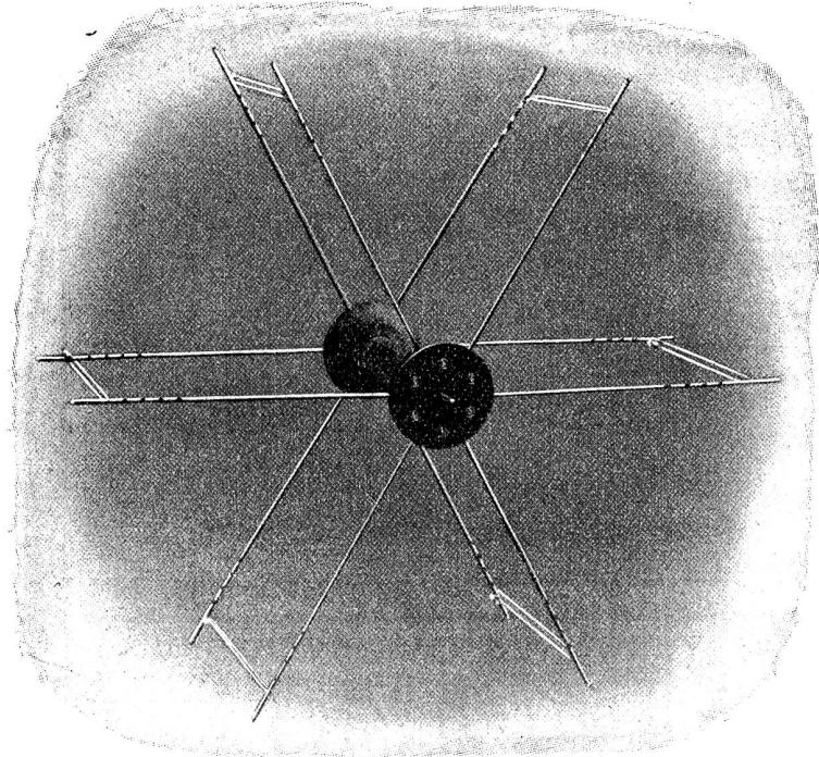
**„Elastic“ montiert.** Kein Brechen der Seitenstäbchen mehr. Höchst **elastische** Auflage für das Material, da die seitlichen **Stahlstäbchen** beim geringsten Zerren des ablaufenden Fadens federnd nachgeben, d. h. sich einbiegen, sodass sich der Faden meist selbst lösen kann, ohne zu zerren.
