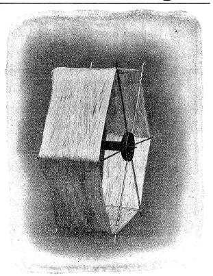
"Dastie" mit aufgelegter Strange. Durch die verblüffend dieses Haspels erhält man eine ca. 30 mm breitere Auflagefläche für das Material, besonders für Seide, Grège etc. von entschiedenem Vorteil.
