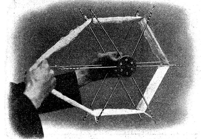
**„Elastic“ beim Auflegen der Strange.** Infolge der grossen Elasticität der Seitenstäbchen ist es möglich, eine neue Strange aufzulegen, ohne die Verbindungsschnürchen in den Auskerbungen nach einwärts verschieben zu müssen.
