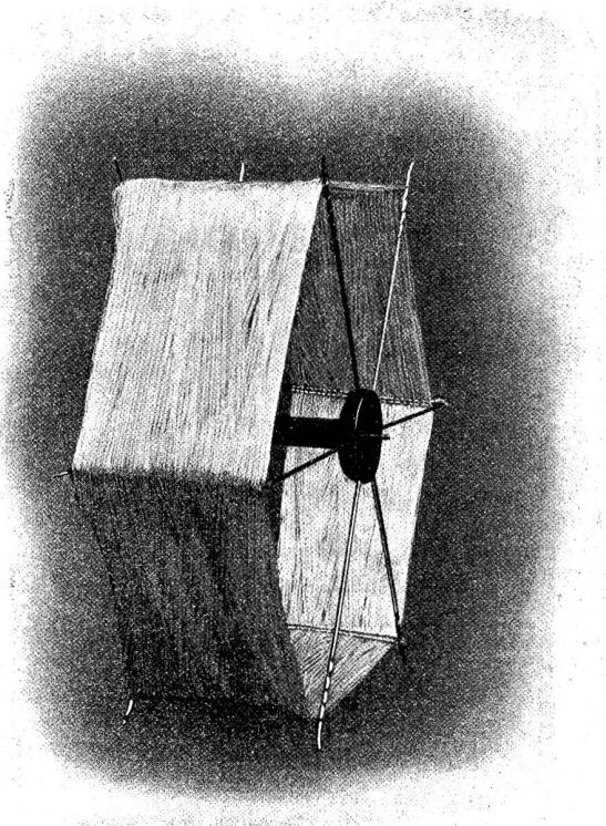
**„Elastic“ mit aufgelegter Strange.** Durch die verblüffend einfache Konstruktion dieses Haspels erhält man eine ca. **30 mm breitere** Auflagefläche für das Material, besonders für Seide, Grège etc. von entschiedenem Vorteil.
