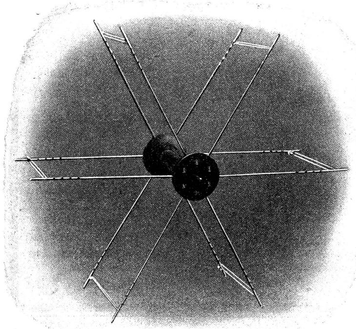
**„Elastic“ montiert.** Kein Brechen der Seitenstäbchen mehr. Höchst **elastische** Auflage für das Material, da die seitlichen **Stahlstäbchen** beim geringsten Zerren des ablaufenden Fadens federnd nachgeben, d. h. sich einbiegen, sodass sich der Faden meist selbst lösen kann, ohne zu zerreißen.
