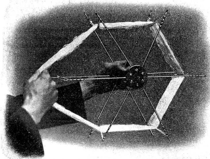
**„Elastic“ beim Auflegen der Strange.** Infolge der grossen Elasticität der Seitenstäbchen ist es möglich, eine neue Strange aufzulegen, ohne die Verbindungsschnürchen in den Auskerbungen nach einwärts verschieben zu müssen.
