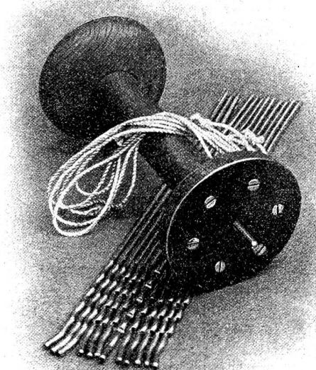
**„Elastic“ demonstriert.** Durch das leichte Demontieren u. Montieren des Haspels kann man durch Auswechseln der Seitenstäbchen **rasch** einen Haspel für grössere oder kleinere Strangenweiten herstellen. Ferner kann der Haspel in demontiertem Zustande versandt werden.
