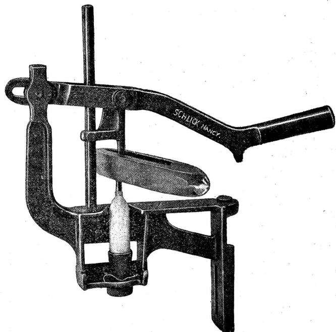
Durch den nachfolgend beschriebenen Apparat sind alle diese Uebelstände beseitigt, indem die auf die Spindel leicht aufgesteckte Bobine mittelst eines Druckes festgesetzt wird.
