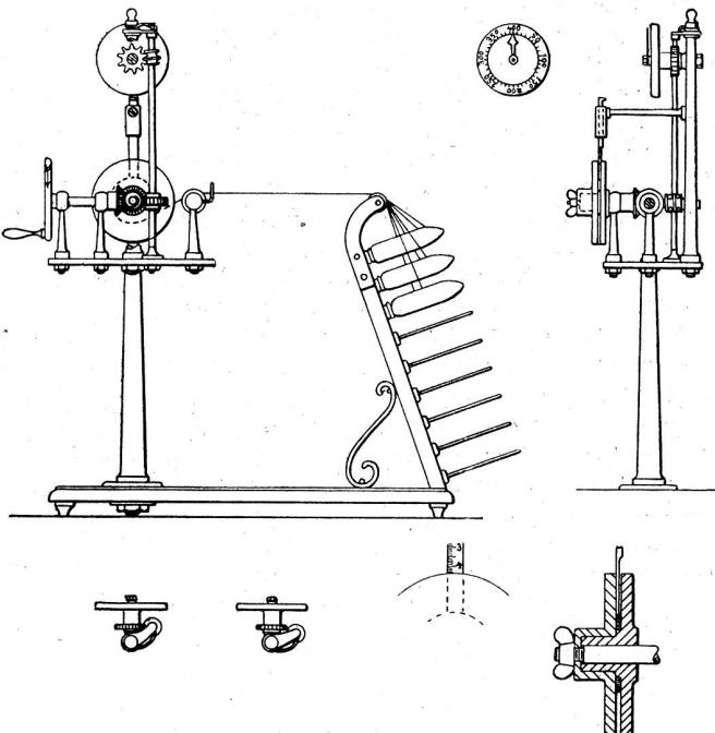
soviel mm wird die Keilstellung nach 20 cm (Schlittenverschiebung 20 cm höher stehen müssen als da, wo die Aufwicklung des Bandes begonnen wurde.
