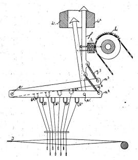
In der Abbildung sind diese Hebel mit a a¹ usw. bezeichnet, b b¹ etc. sind Schlaufen, an denen die Harnischschnure hängen. Die Hebel a a¹ sind bei c drehbar und bei e stehen sie gelenkig mit den Platinen f in Verbindung, die durch Federn g gegen die Nadeln h gedrängt werden. Der Drehpunkt c der Hebel a liegt ungefähr oberhalb der Stelle, an der das Riet d den Schuss an die Ware anpresst. Die Maschine ist mit zwei Messern i i¹ versehen, die nach
