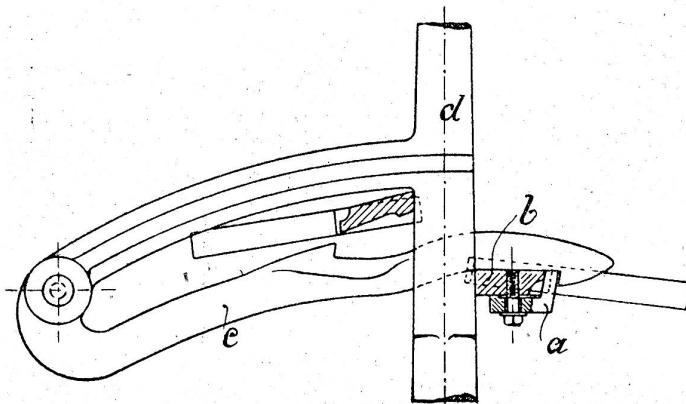
Um den unbelasteten, leer mitgehenden Schäften eine sichere Führung zu geben, werden nach den Ausführungen des Patentnehmers, D. R.-P. Nr. 188,811 an den unteren Schaftmessern b Einsatzstücke a angebracht, die den beim Arbeiten zum richtigen Einfallen notwendigen Spielraum zwischen dem Messer und den Platinen c ausfüllen. Die Schäfte d werden dadurch festgehalten und sie können nicht hin und her geschleudert werden. Dadurch wird eine rasche Abnutzung der Teile vermieden.
