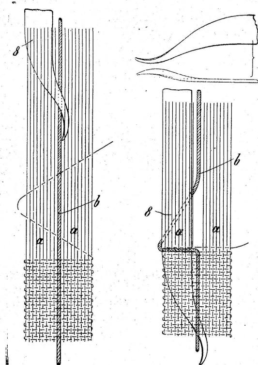
durch, dass man die Schnur wieder im Grundgewebe einbinden lässt.
