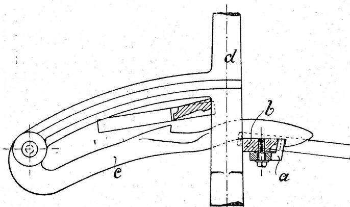
Um den unbelasteten, leer mitgehenden Schäften eine sichere Führung zu geben, werden nach den Ausführungen des Patentnehmers, D. R.-P. Nr. 188,811 an den unteren Schaftmessern b Einsatzstücke a angebracht, die den beim Arbeiten zum richtigen Einfallen notwendigen Spielraum zwischen dem Messer und den Platinen c ausfüllen. Die Schäfte d werden dadurch festgehalten und sie können nicht hin und her geschleudert werden. Dadurch wird eine rasche Abnutzung der Teile vermieden.
