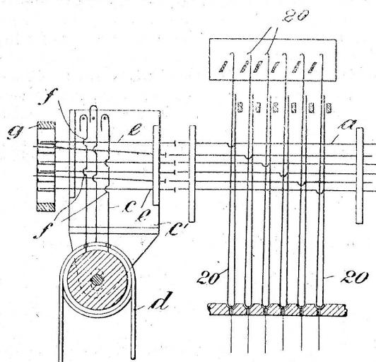
werden, dann wird der Rahmen c<sup>1</sup> ausgewechselt und durch einen Rahmen ersetzt, in welchem jede Hilfsnadel c mit drei Oesen f drei Stossnadeln e umgreift.
