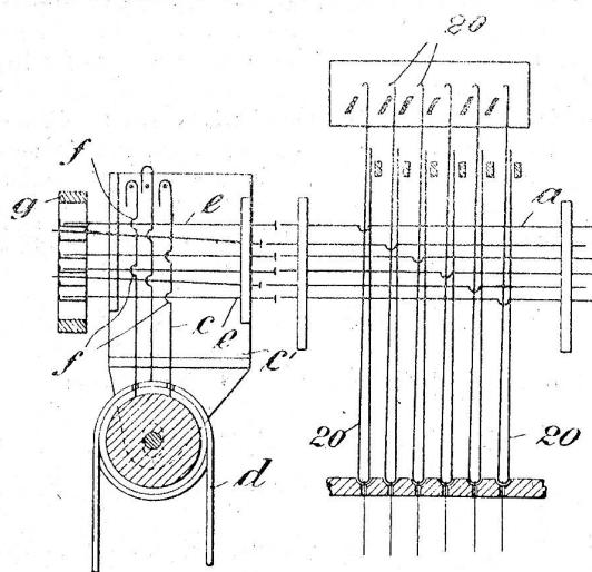
werden, dann wird der Rahmen  $c^1$  ausgewechselt und durch einen Rahmen ersetzt, in welchem jede Hilfsnadel  $c$  mit drei Oesen  $f$  drei Stossnadeln  $e$  umgreift.
