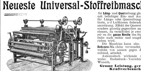
für Läng- und Querreibung gleichzeitig, mit beliebiger Ein- und Ausrückung für Längs- oder Querreibung. Paten-tierte, auf Luftkissen federnde Musseranordnung. Effekt der Querreibung besonders günstig gegenüber andern Systemen, da vermittelst je zwei Messerrei en die ganze Breite des Stoffes von links nach rechts und umgekehrt gerieben wird.
