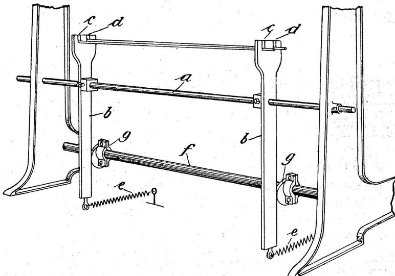
Diese Vorrichtung bietet zudem den Vorteil, dass die Kreuzschienen beim Lösen und Zurücklassen des Zetts diesen halten, so dass er nicht mehr mit Webstuhlbestandteilen in Berührung kommen und beschmutzt werden kann.
