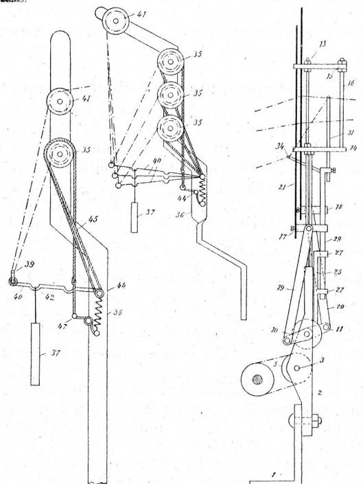
Doppelösenneedeln findet dabei jeweils in ihrer Tieflage statt, wobei die Lage der Oesen in den Doppelösenneedeln 21, sowie der Dreherösenneedeln 31 derart ist, dass bei der Tieflage der Dreherfäden die Stehfäden über den Spitzen der Dreher-Nadelstange 31 gehalten sind, um die seitliche Verschiebung der Nadelstange zu ermöglichen.
