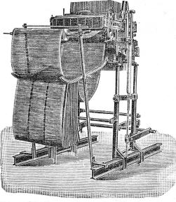
Automatische Kartenschlagmaschinen mit 1344 Stempel. D. R.-Pat. No. 103233.
