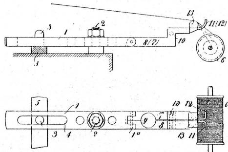
versehenen Schraube 10 kann der Schlitz zwischen den Stäben 7 und 8 der Dicke des Garnes entsprechend verstellt werden. Mit 11 und 12 sind die leitenden Führerdrähte bezeichnet und 13 ist eine stabförmige Erhöhung, über die der Faden, der auf der Spule 6 aufgewunden wird, gleitet.
