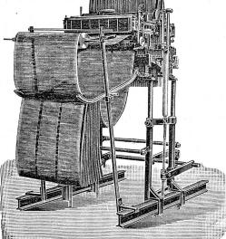
Automatische Kartenschlagmaschinen mit 1344 Stempel. D. R.-Pat. No. 103233.
