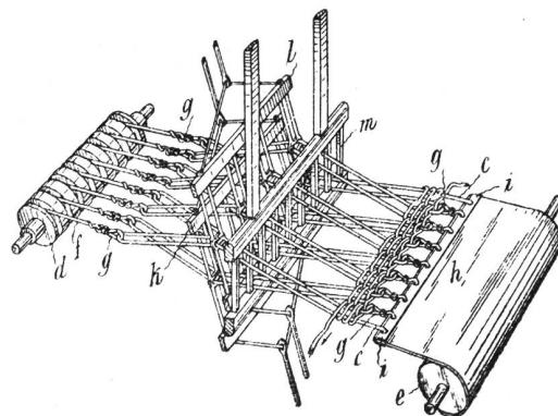
Zunächst werden die beiden Fadenenden der Kette an einem am Warenbaum *e* angebrachten Tuche *h* befestigt oder an der Schiene *i*. Das Tuch *h* ist mit Karabinerhaken *g* ausgestattet, an denen man die Kettenschleifen der einen Seite anhängt. Sodann wird
