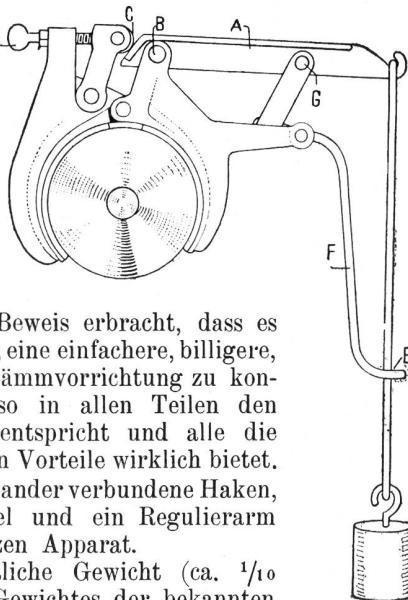
also bei jedem Schuss, wird die Bremse auf diese Weise um eine Idee ausgelöst und bleibt somit beständig in ihrer gleichen Lage hängen, die angehängten Gewichte mögen noch so schwer, die Schusszahl noch so hoch sein.
