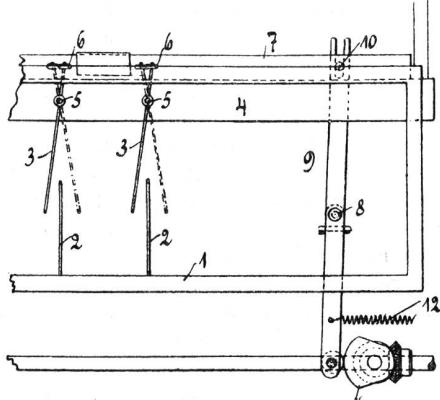
Sie sind bei 5 drehbar am Schaftstäbe 4 so angeordnet, dass sie oberhalb der Nadeln 2 für die Stehfäden schwingen können, die im Schafte 1 befestigt sind.
