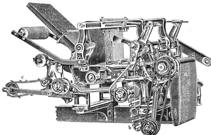
Schaftmaschine mit Papierdessin-Cylinder und Holzkarten-Cylinder, automatische Umschaltung beider Cylinder, zweckmäßig für Servietten- und Foulardfabrikation etc.
