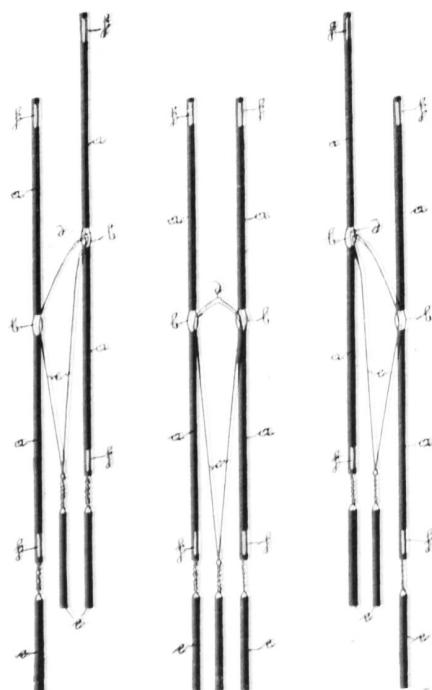
Vorliegende Jacquarddreherlitze besteht aus einer winklich gebogenen Halblitze aus rundem Stahldraht
