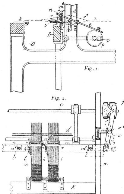
*a* ist das Gestell des Stuhles, *b* die Lade mit dem Rietblatt *v*, welche von der Welle *c* aus in bekannter Weise in Schwingung versetzt wird, *d* sind die Schäfte,
