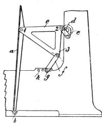
das mit einem Ende bei 1 mit der bei & drehbar gelagerten Ladenschwinge a gelenkig verbunden ist und bei dem anderen Ende 2 mit der kurzen Kurbelstange d. Die dritte, nach abwärts gerichtete Ecke 3 ist mit einer Stange f gleichfalls gelenkig verbunden, die bei g im Gestelle ihren Dreh-
