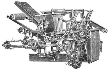
Schaftmaschine mit Papierdessin-Cylinder und Holzkarten-Cylinder, utomatische Umschaltung beider Cylinder, zweckmässig für **Servietten**und **Fonlardfabrikation** etc.
