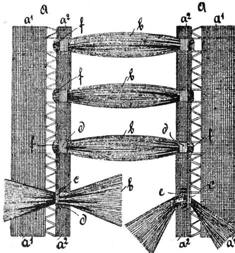
durch deren Entfernung von einander die Länge der Quästchen. Diese werden durch das Eintragen eines besonderen Schusses gebildet, den man, je nach der gewünschten Dicke der Fransen öfter in ein und dasselbe Fach einträgt. Die Quästchen werden so eingebunden, dass ein Teil *c* der Kettenfäden von dem Fadenbündel umschlungen wird, während ein Teil *d* der Kette über und ein anderer Teil *e* unter dem Fadenbündel flott liegen.
