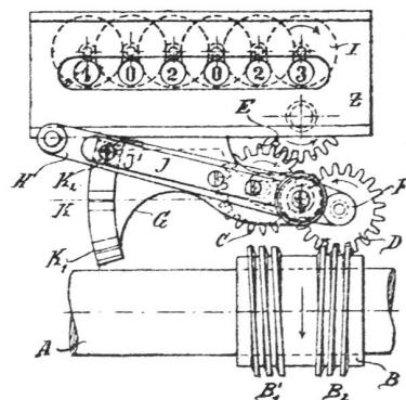
$B_1$  und das Werk zählt vorwärts. Wird  $H$  so eingestellt, dass die Nase  $I^1$  bei  $K^2$  einschnappt, so treibt die Schnecke  $B_1$  das Zählwerk in der entgegengesetzten Richtung.  $K$  bezeichnet einen Einschnitt der für die Abstellung des Zählwerkes dient. Eine andere Art der Anordnung dieses Zählers ist die, dass man die
