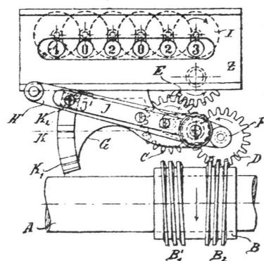
B<sub>1</sub> und das Werk zählt vorwärts. Wird H so eingestellt, dass die Nase I<sup>1</sup> bei K<sup>2</sup> einschnappt, so treibt die Schnecke B<sub>1</sub> das Zählwerk in der entgegengesetzten Richtung. K bezeichnet einen Einschnitt der für die Abstellung des Zählwerkes dient. Eine andere Art der Anordnung dieses Zählers ist die, dass man die
