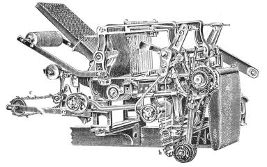
Schaftmaschine mit Papierdessin-Cylinder und Holzkarten-Cylinder, automatische Umschaltung beider Cylinder, zweckmässig für **Servietten**und **Foulardíabrikation** etc.
