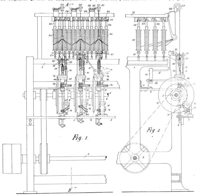
horizontal von der Tragschiene 2 abstehenden Armen 9 auf- und abbewegbar gelagert. Die Büchse 40 ist dreh- und verschiebbar auf der Büchse 8 jedes Spulendornes aufgesetzt. Der Unterteil der Büchse 40 ist als Zahnkolben 10 und der Oberteil als Scheibe 11 ausgebildet. Die unter die Scheiben 11 auf die Büchse 40 geschraubten Friktionsscheiben (Wirtel oder Rollen)
