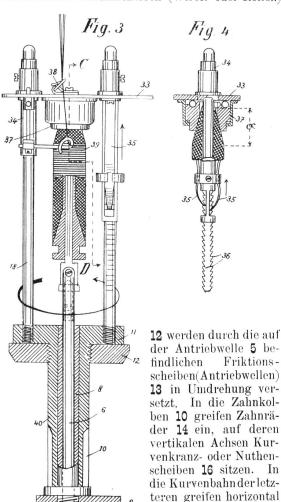
der Antriebwelle 5 be-Friktionsscheiben(Antriebwellen) 13 in Umdrehung versetzt. In die Zahnkolben 10 greifen Zahnräder 14 ein, auf deren vertikalen Achsen Kurvenkranz- oder Nuthen-scheiben **16** sitzen. In die Kurvenbahnderletzteren greifen horizontal von den Spulendornen abstehende, auf densel-ben verstellbar befestigte Stiften 17 ein, wo-
