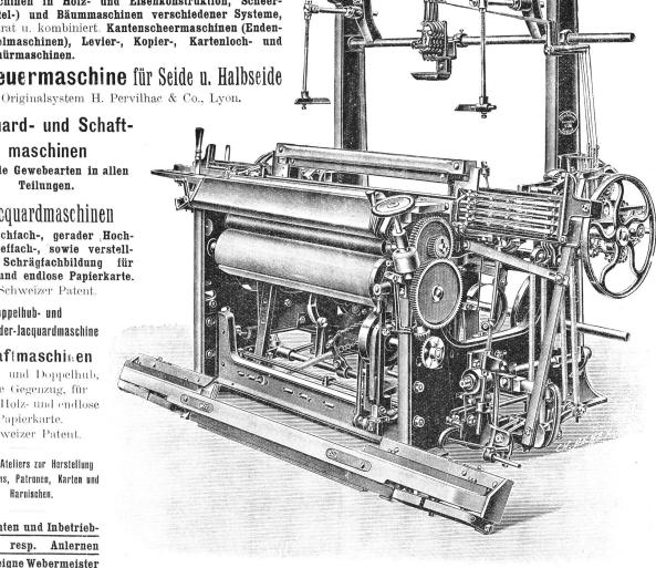
Kom binierter Wechselstuhl mit separater Unilade.
