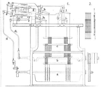
Trotz der grossen Anzahl Schaftschwingen und der doppelten Einrichtung ist die Maschine im Ganzen doch sehr einfach, arbeitet absolut ruhig und mit der gleichen Tourenzahl, die bei gewöhnlichen Schaftmaschinen und den zu webenden Artikeln zulässig erscheint. Ein Weber kann bei einigermassen gutem Material zwei Stühle mit solchen Schaftmaschinen versehen. Dies ist in der Weberei, wo diese Maschine erfunden worden, effektiv der Fall.
