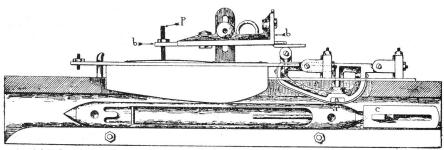
Ansicht des Apparates mit dem Schützen zur Zeit, da dieser ganz in den Kasten getreten ist und infolge seiner eigenen Tätigkeit gegen die kleine Zunge durch die grosse Zunge des Apparates festgehalten wird.
