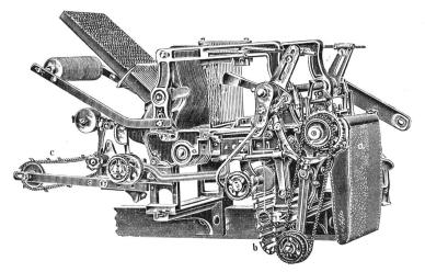
Schaftmaschine mit Papierdessin-Cylinder und Holzkarten-Cylinder, utomatische Umschaltung beider Cylinder, zweckmässig für **Servietten-** und **Foulardíabrikation** etc.
