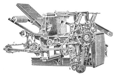
Schaftmaschine mit Papierdessin-Cylinder und Holzkarten-Cylinder, utomatische Umschaltung beider Cylinder, zweckmässig für **Servietten**und **Foulardfabrikation** etc.
