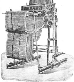
Automatische Kartenschlagmaschinen mit 1344 Stempel. D. R.-Pat. No. 103233.
